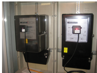
Abbildung 2.7.: Testaufbau mit zwei Ferraris-Leseköpfen
