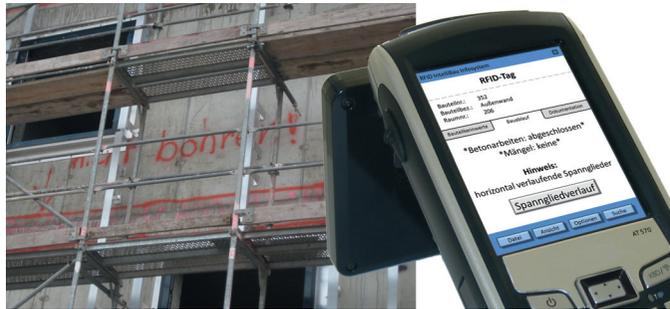
Abb. 2: Prozesssteuerung und Dokumentation im Bauablauf durch intelligente Bauteile
