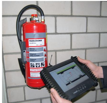
Abb. 3: BIM-/RFID-basierte Ortungs- und Navigationslösung zur Durchführung von Wartungsprozessen
